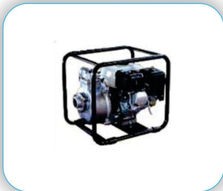
**SST-50 y SST-80 (bombeo de agua con sólidos):** Cuerpo de bomba en aluminio con excelente acabado, voluta en hierro fundido, impulsor semi-abierto en hierro fundido (FC-200).
